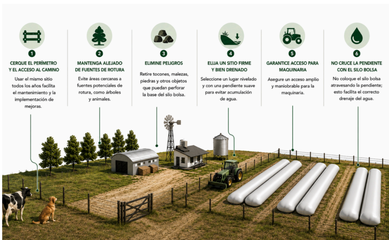
Figura 6. Esquema de emplazamiento correcto de un playón de silo bolsas: limpieza, nivelación, buen acceso, agrupamiento de a 2-4, distancias entre bolsas y entre grupos, cerco perimetral.
