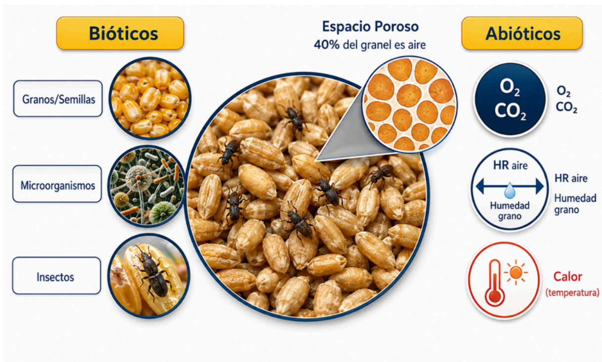
Figura 2. Componentes del ecosistema de granos almacenados: componentes bióticos y abióticos, espacio poroso
